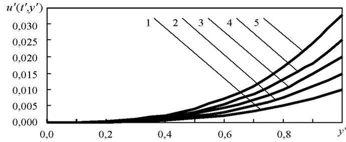
Рис. Профили безразмерной скорости в канале для следующих значений некоторых параметров  $\dot{\gamma}_{crit1} = 0,1$ ,  $V'_\infty = 10$ ,  $a = 0,5$  при  $t' = 2 \cdot 10^{-3}$  (1);  $3 \cdot 10^{-3}$  (2);  $4 \cdot 10^{-3}$  (3);  $5 \cdot 10^{-3}$  (4);  $6,69 \cdot 10^{-3}$  (5).
